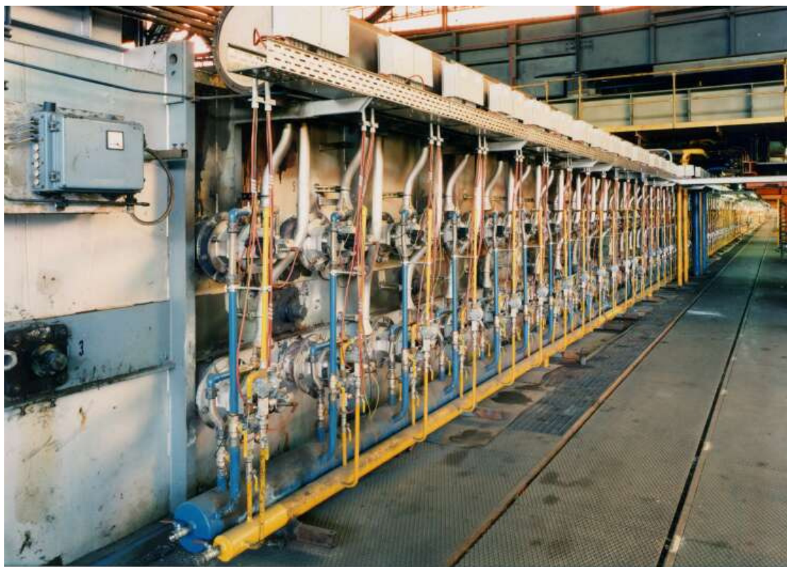
Рисунок 7: Горелки с SiSiC излучающими трубами, расположенные в горизонтальной линии по отжигу кремнесодержащей металлической ленты
